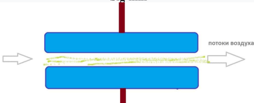
Shakl. 4. Kapasitiv namlik datchikining ishlash printsipi
