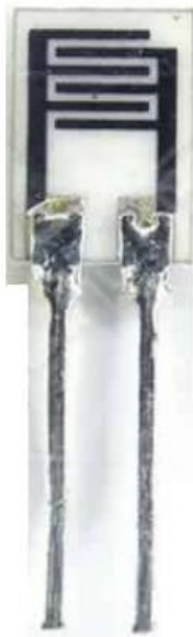
Shakl. 3. Rezistiv namlik datchiki qurilmasi
